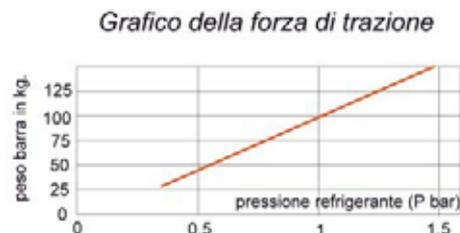
Il grafico illustra la pressione del refrigerante necessaria per trainare una barra in funzione del suo peso, e con un coefficiente d'attrito valutato < 0,2
